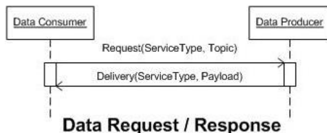
Abbildung 2: Anfrage mit synchroner Antwort (Abbildung entnommen aus SIRI, (CEN, TS 15531 Part 2, 2011)).
