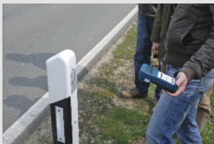
Bild 11: Bediengerät zur Vor-Ort-Kontrolle (Foto: DTV-Verkehrsconsult GmbH)
