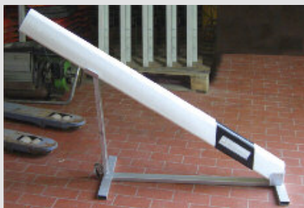
Bild 10: Hilfsmittel zur Vorbereitung der Leitpfostenzählgeräte (Foto: Landkreis Biberach)
