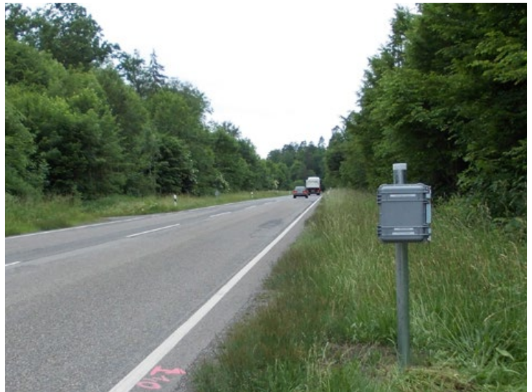
Abb.: Kasten-Zählgerät mit Seitenradartechnik
